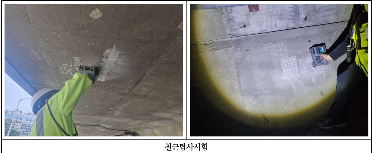
【사진 3.36】 철근탐사시험 현장사진
